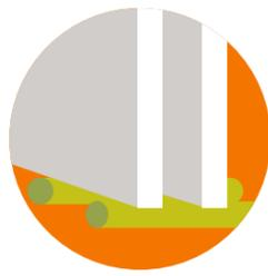
Si requieres almacenar temporalmente los tableros de manera vertical, se recomienda apoyarlos en rodillos plásticos para no dañar el borde de apoyo al momento de sacar el tablero.
