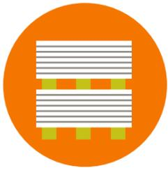
Coloca soportes de separación entre cada paquete sobre todo si ha sido abierto.
